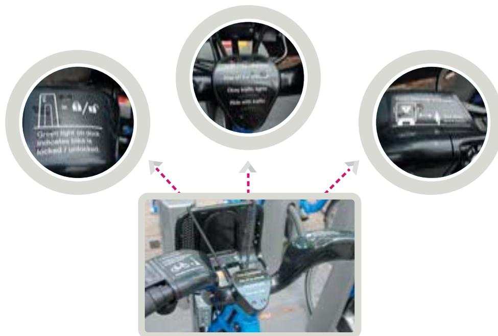
Nueva York, Elementos plásticos de protección en la parte frontal (dirección y cabezote) para los cables de freno. Son particularmente útiles, no solamente para evitar el contacto y evitar el vandalismo, sino también para anunciar e informar sobre temas esenciales de seguridad y de prevención.
